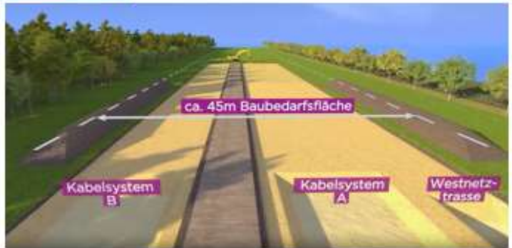
45 m Baubedarfsfläche, sukzessive Inanspruchnahme (erst Westnetztrasse, dann Kabelsystem A, dann Kabelsystem B)
