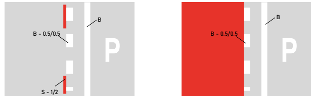
Bild 6: Prinzipskizze der beiden Markierungsvarianten neben Kfz-Parkständen
