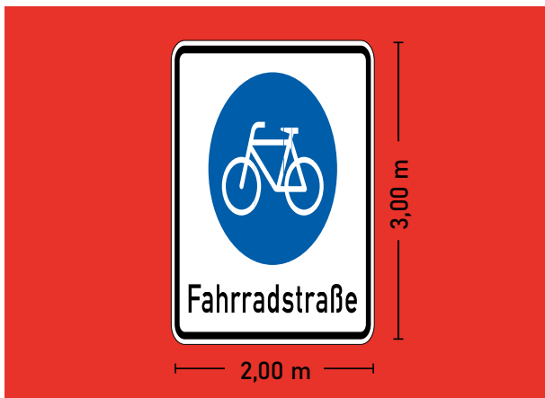
Bild 3: Prinzipskizze einer überhöhten Darstellung des Piktogramms „Beginn einer Fahrradstraße“ auf Rotmarkierung
