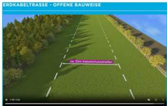
ca. 32 m Kabelschutzstreifen
