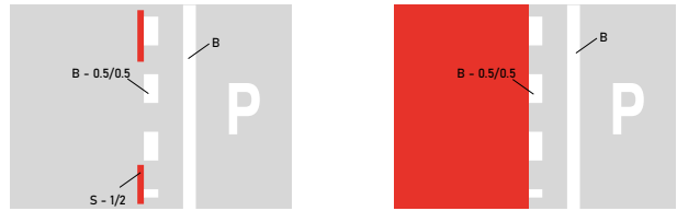
Bild 6: Prinzipskizze der beiden Markierungsvarianten neben Kfz-Parkständen
