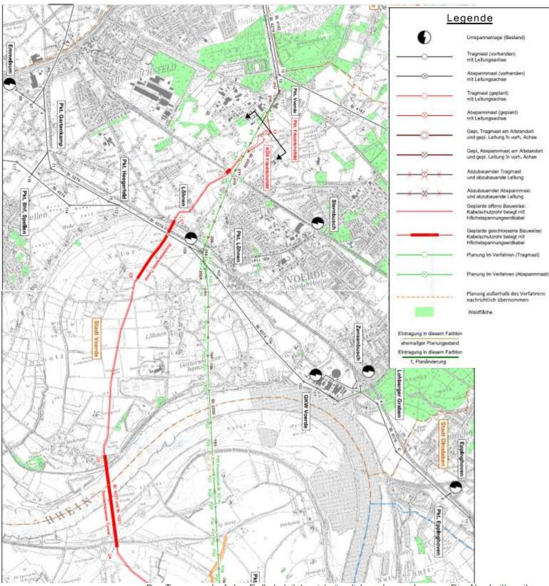
Auszug Übersichtskarte Amprion GmbH zur Offenlage 01.08.2023 bis 31.08.2023 Der Trassenverlauf des Erdkabelpiloten ist räumlich grob zu erkennen. Die Abschnitte mit geschlossener Bauweise sind mit einer größeren Strichstärke hervorgehoben. Außerdem sind die KÜS-Standorte und die Übergangsbauwerke (Ü1 – Ü4) gekennzeichnet. Sämtliche dauerhaften Planungen sind farblich rot, der Bestand ist in schwarz dargestellt. Der Trassenverlauf des Freileitungsprovisoriums ist in grünem Farbton dargestellt.
