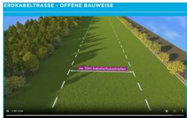
ca. 32 m Kabelschutzstreifen
