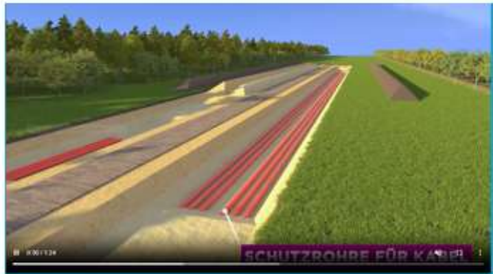
Schutzrohre für Kabel
