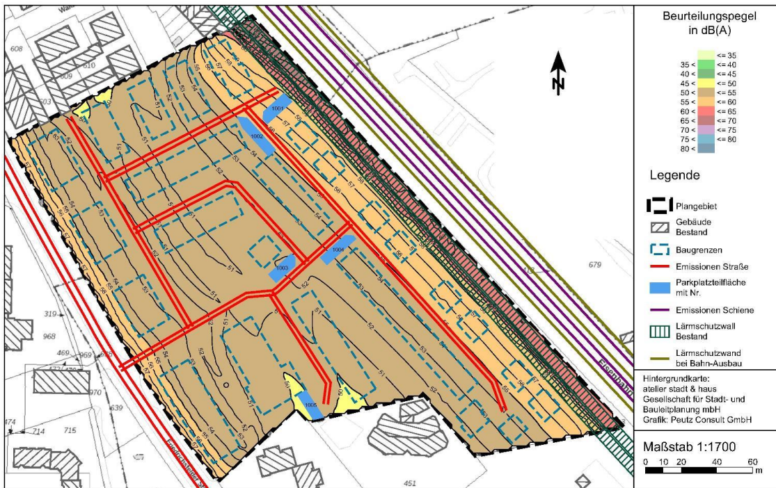
Abbildung: Beurteilungspegel aus Verkehrslärm zur Tages- und Nachtzeit (aus der schalltechnischen Untersuchung zum Bebauungsplanverfahren, (Peutz Consult, Düsseldorf, 20.06.2022))
