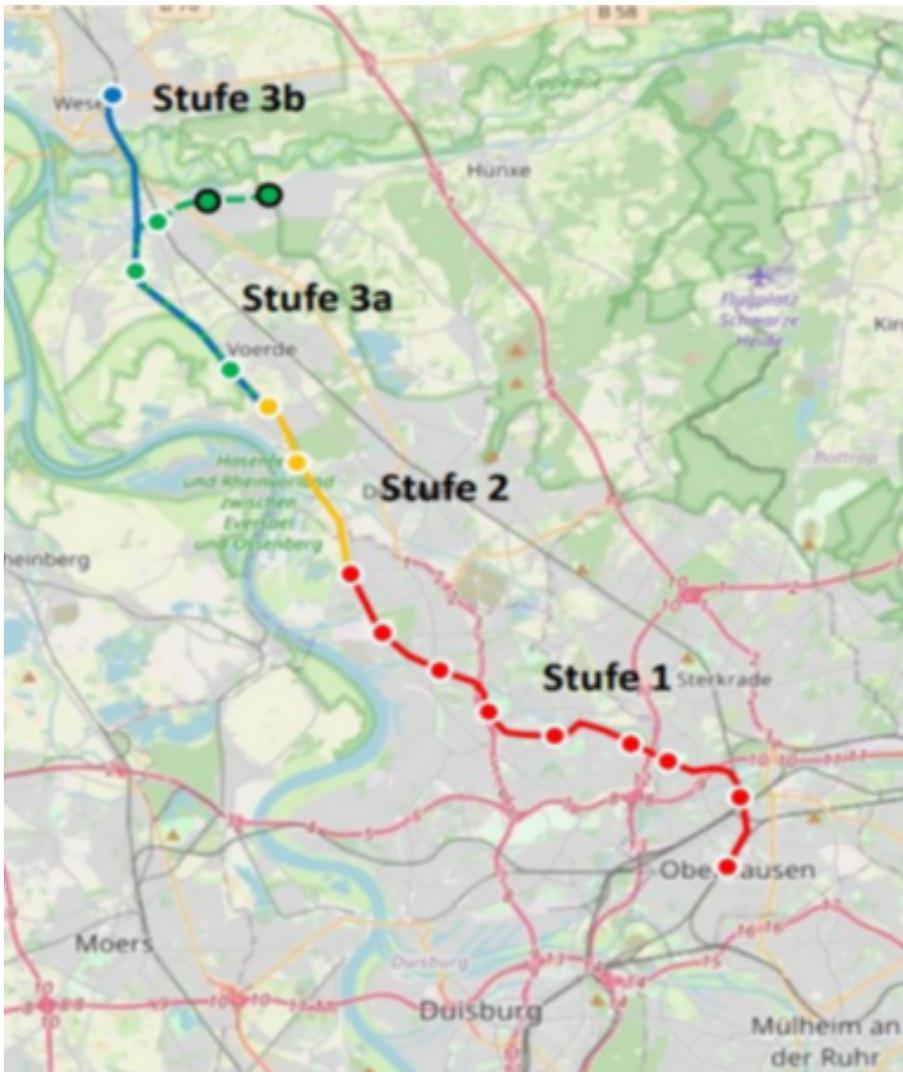
Die Stufe 3 sieht zwei alternative Routen vor, die **nicht** beide gebaut werden und somit als Alternativen zu verstehen sind. In der Stufe 3a wird die Strecke über Voerde-West und Spellen über einen einzurichtenden Bahnhof Friedrichsfeld tief und Kurierweg bis nach Hünxe-Bucholtswelmen weitergeführt. Hierbei werden die bestehenden Eisenbahnstrecken
