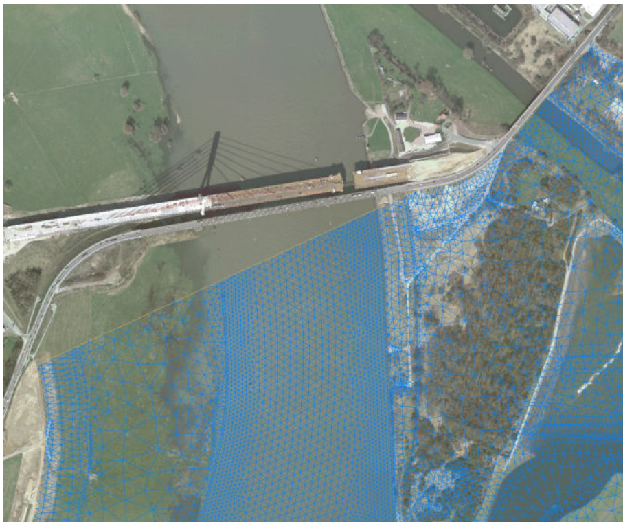
Abbildung 3: Modelauslauftrand des digitalen Strömungsmodells; Kartengrundlage DOP © Geobasis NRW 2011;
