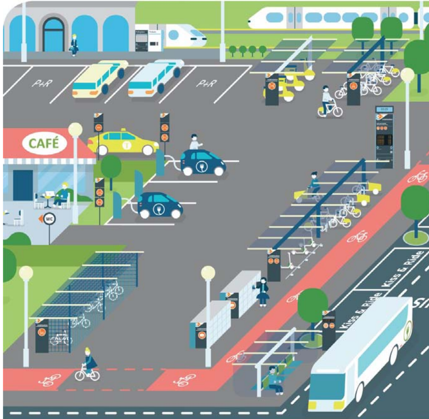
Abbildung 37: Prinzip-Darstellung zur Funktionalität einer Mobilstation, Quelle: NVR
