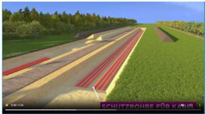
Schutzrohre für Kabel
