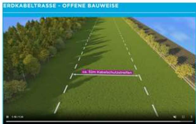
ca. 32 m Kabelschutzstreifen
