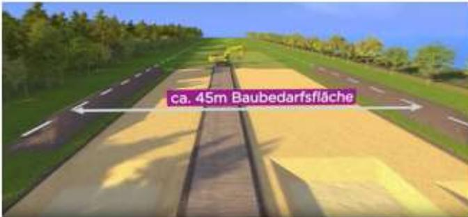
45 m Baubedarfsfläche, sukzessive Inanspruchnahme (erst Westnetztrasse, dann Kabelsystem A, dann Kabelsystem B)
